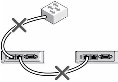
**Abbildung 5. Inkorrekte Verkabelung für CMC-Netzwerk - 2 CMCs**
