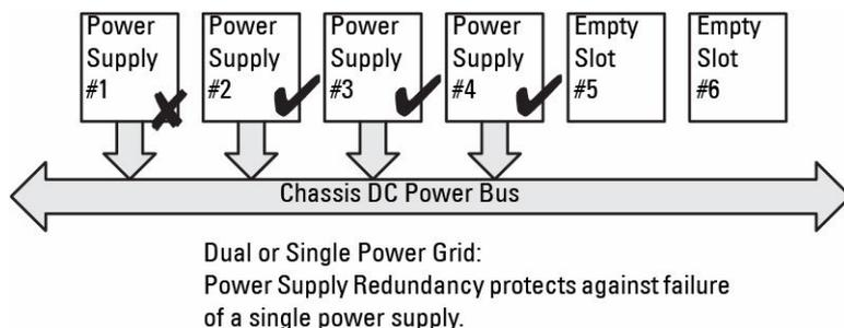
Abbildung 15. Netzteilredundanz: Insgesamt 4 Netzteilereinheiten bei Ausfall einer Netzteilereinheit.
