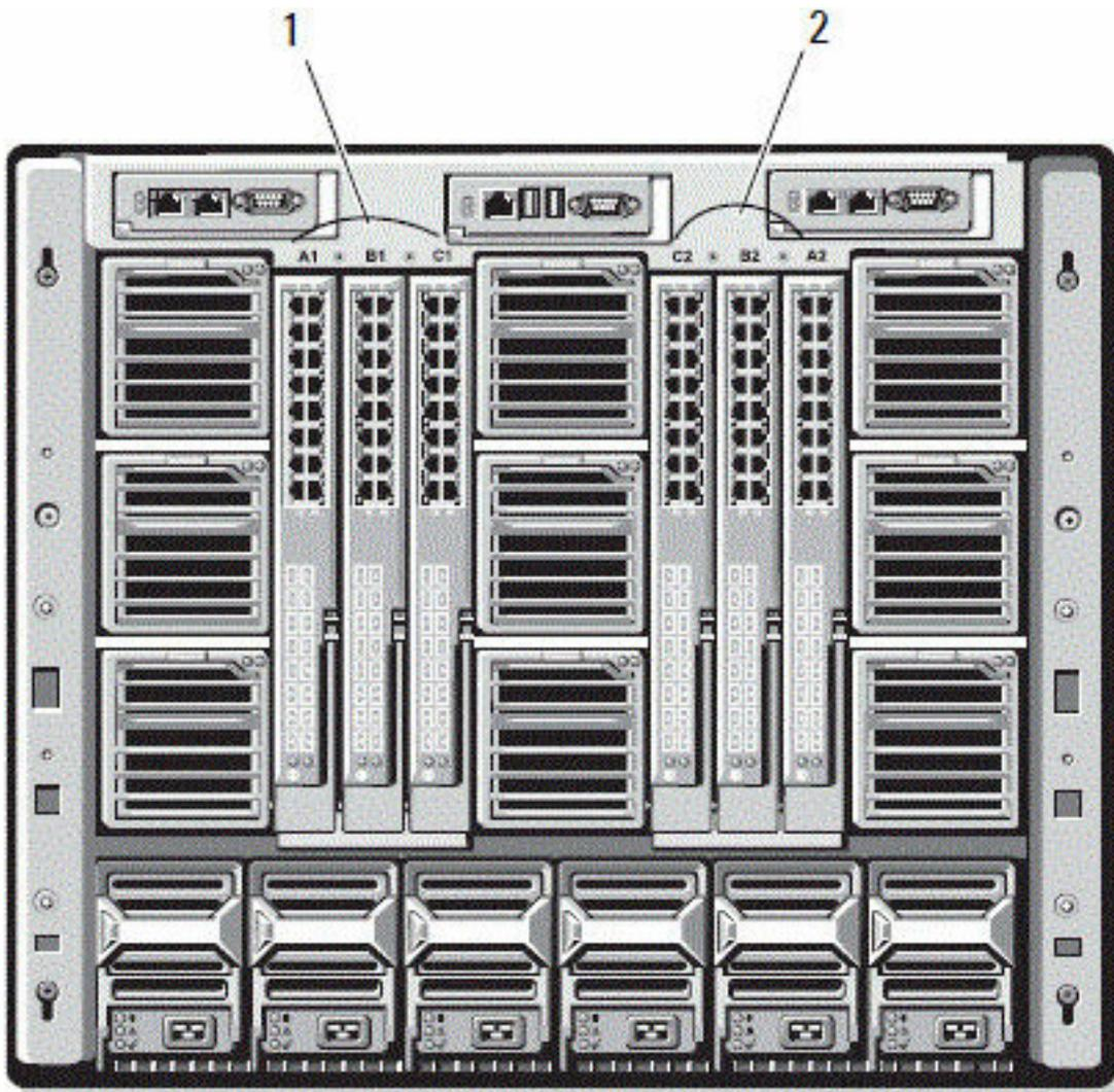
**Abbildung 13. Rückansicht eines Gehäuses mit ausgewiesenen EAM-Standorten**
