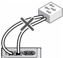
**Abbildung 4. Inkorrekte Verkabelung für CMC-Netzwerk - 1 CMC**
