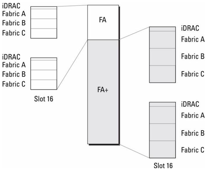
**Abbildung 12. Funktionsvergleich FlexAddress (FA) gegenüber FlexPlusAddress (FA+)**
