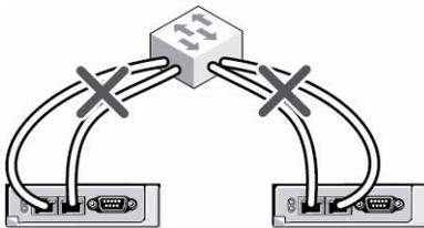
**Abbildung 3. Inkorrekte Verkabelung für CMC-Netzwerk - 2 CMCs**
