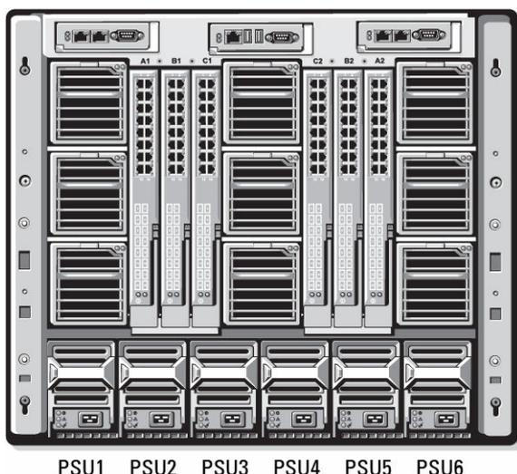
**Abbildung 17. Gehäuse mit einer Konfiguration für sechs Netzteileneinheiten**
