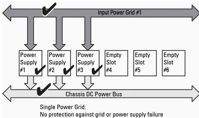
**Abbildung 16. „Keine Redundanz“ bei drei Netzteileneinheiten im Gehäuse**
