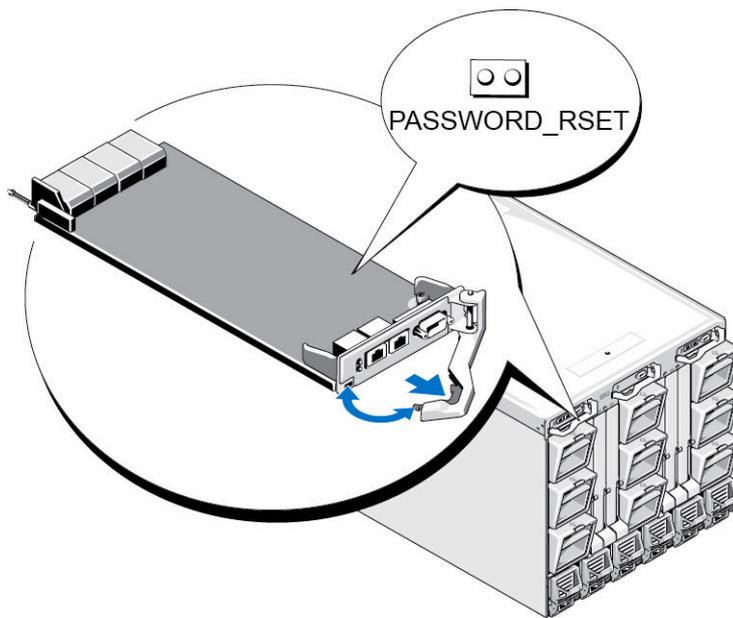
Abbildung 18. Kennwort-Reset-Jumperposition
